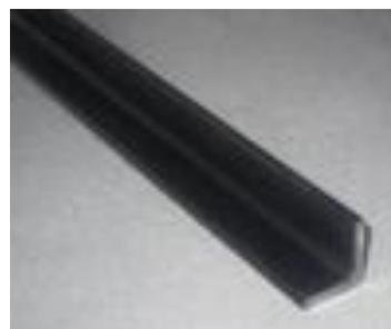
*\* Cornière de 60 : L 60\*60\*7/8, longueur de 2 mètres percée de 5 trous pour un poids d'environ 13 kilos, ce produit en acier dur est issu d'un re-laminage de rail de chemin de fer. Piquet très résistant, destiné également à tous types de clôture (gros bétails).*
