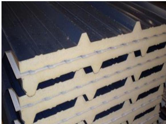
*Panneau nervuré pour toiture avec une structure acier composé d'isolants à base de polyuréthane, mousse prise entre deux tôles d'acier, ou de laine de roche (obligatoire pour l'accueil du public). Ce panneau isolant, produit de référence sur le marché de la toiture, offre une solution globale, pratique et économique pour la réparation ou la construction de bâtiments acier.*
